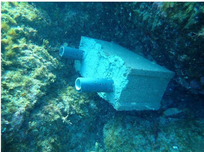
Fig. 8. Estructura fondeada en una de las localidades de estudio con los sensores de registro continuo de temperatura y pH del agua de mar (HOBO MX2501), protegidos en el interior de tubos de PVC.
