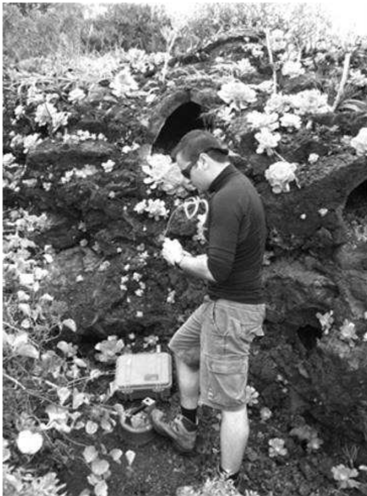
Fig. 8. Cayetano Guillén realizando medidas de flujo difuso de \text{CO}_2 mediante un equipo portátil.
