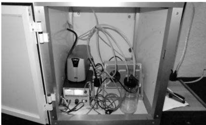
Fig. 13. Imagen de la estación geoquímica automática HIE02 en el pozo San Simón.
