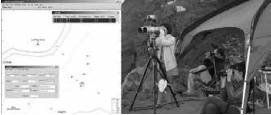
Fig. 5. Estación de muestreo de zifios y otros cetáceos desde acantilados en tierra, con unos prismáticos de 15x70 cubriendo el área más lejana y dos prismáticos de 7x50 muestreando más cerca de costa. Los prismáticos van equipados con compás y retícula para determinar la localización de los avistamientos. Los datos se registran en tiempo real en un ordenador que plasma en un mapa los avistamientos y tiene herramientas para facilitar el seguimiento de los grupos.
