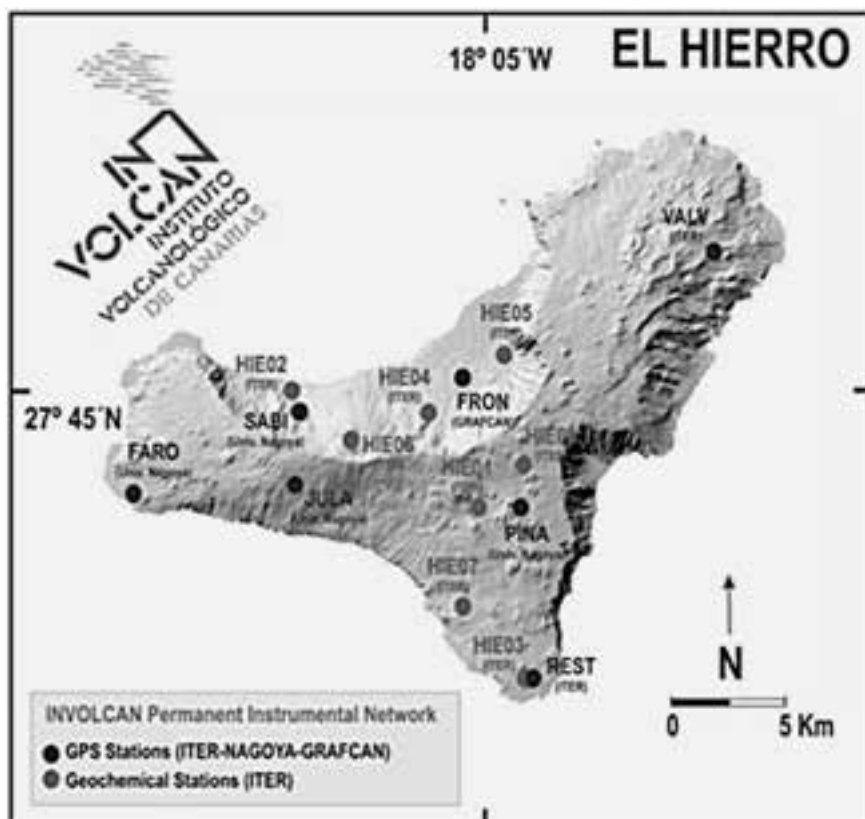
Fig. 1. Red instrumental geoquímica y geodésica permanente del INVOLCAN para la vigilancia volcánica en la isla de El Hierro.
