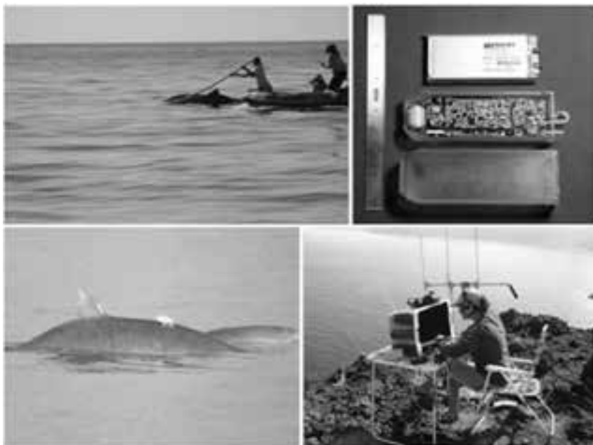
Fig. 8. Las marcas DTag son un ordenador miniaturizado, con una batería de alta densidad que alimenta la electrónica y el hidrófono. Todo ello se introduce en una carcasa estanca que puede sumergirse hasta 3000 m. Se coloca con un mástil en el lomo del animal, al que se adhiere con ventosas. El seguimiento se realiza por radio VHF y la marca se recupera una vez se libera del animal tras un tiempo programado de grabación.
