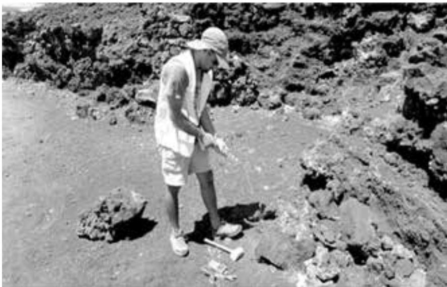
Fig. 9. Germán Padilla realizando la toma de muestras de gases en la atmósfera del suelo.
